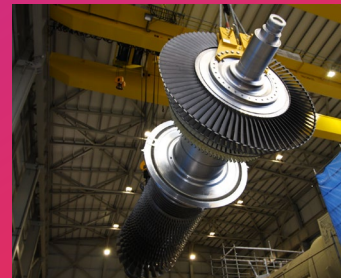
Inspección Triple C de las turbinas y el alternador de la CCPP Soto V, España
