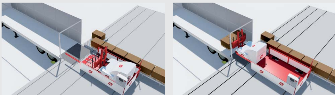
DAP loading. Carga del DAP* (*Sistema de alimentación). Feeding from DAP to the NALON N8. Alimentación del DAP al NALON N8.
