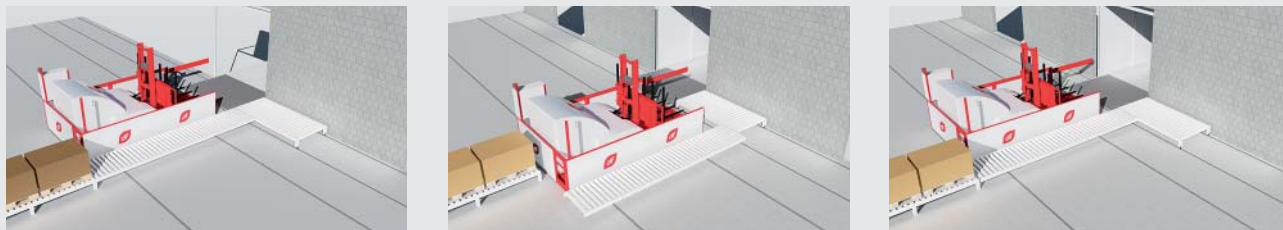
Moving towards selected loading dock. Desplazamiento hacia el muelle de carga seleccionado. Positioning on the selected loading dock. Posicionamiento en el muelle de carga seleccionado. Alignment with the central axis of the truck. Alineación con el eje de simetría del remolque/contenedor.
